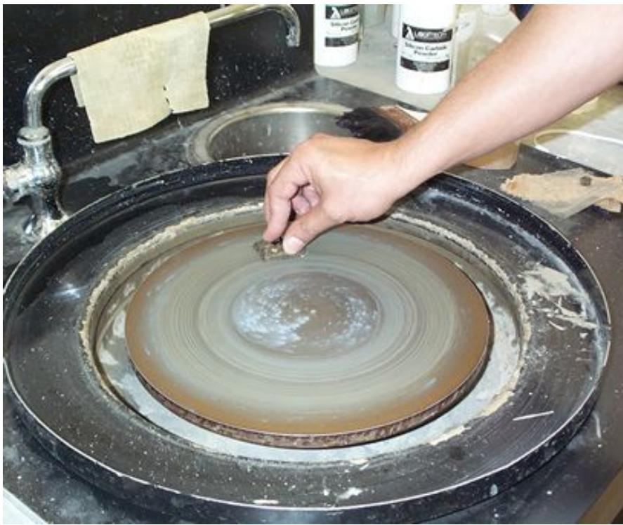
شکل ۲-۴- مرحله سایش نمونه به روش دستی
