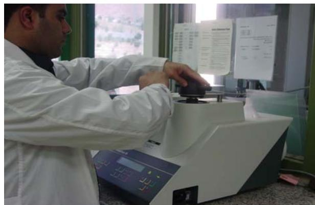
شکل ۲-۹- دستگاه پرس نمونه برای تهییه نمونه‌های صیقلی به روش گرم
