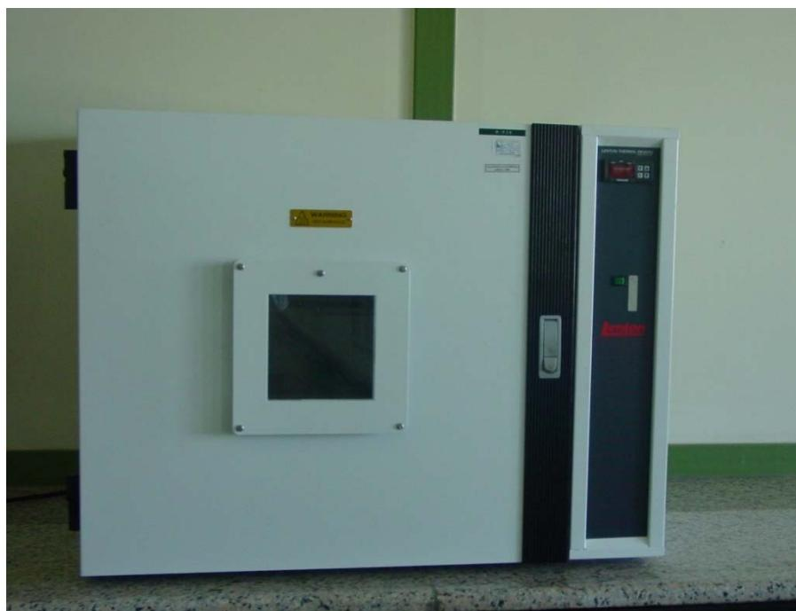
شکل ۲-۱- دستگاه آون برای خشک کردن نمونه‌های مرطوب
