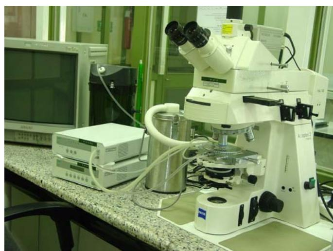
شکل ۱-۵- میکروسکوپ مجهز به صفحه گرم‌کننده و سردکننده
