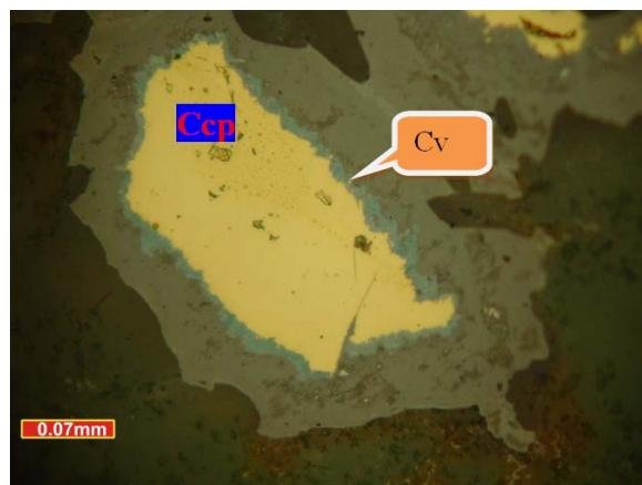
شکل ۶-۲- تصویر میکروسکوپی جانشینی کولولیت به جای کالکوپیریت (نور انعکاسی PPL) کالکوپیریت (Cep) و کولولیت (Cv)
