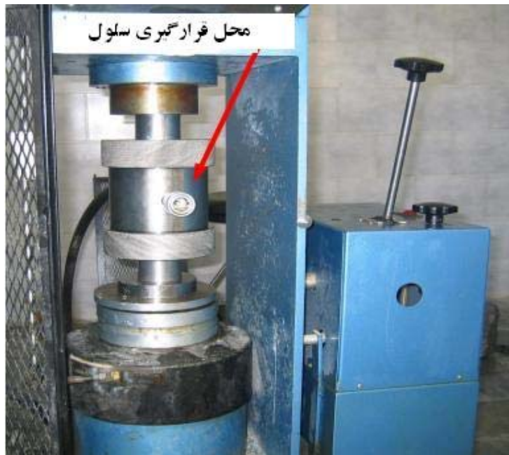
شکل ۳- دستگاه مقاومت فشاری و نحوه قرارگیری سلول در بین جک‌ها
